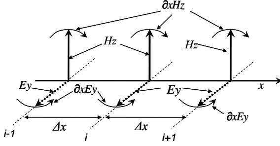
図2 CIP法解析における1次元のグリッドモデル
