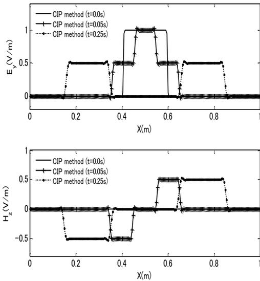
図6 CIP法による電界と磁界の伝播
