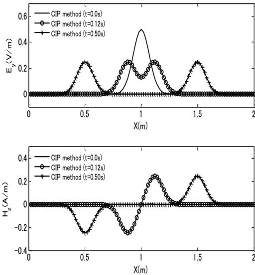
図4 CIP法による電界と磁界の伝播
